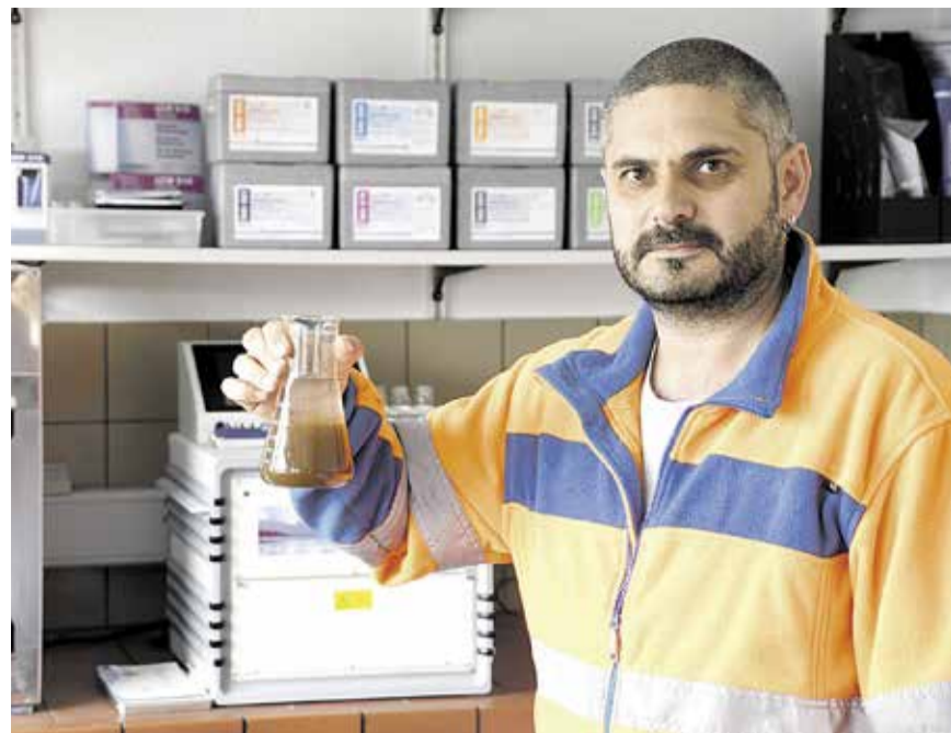
Andreas Lehr zeigt im Labor, wie schnell sich im fast fertig gereinigten Wasser die Feststoffe absetzen.
